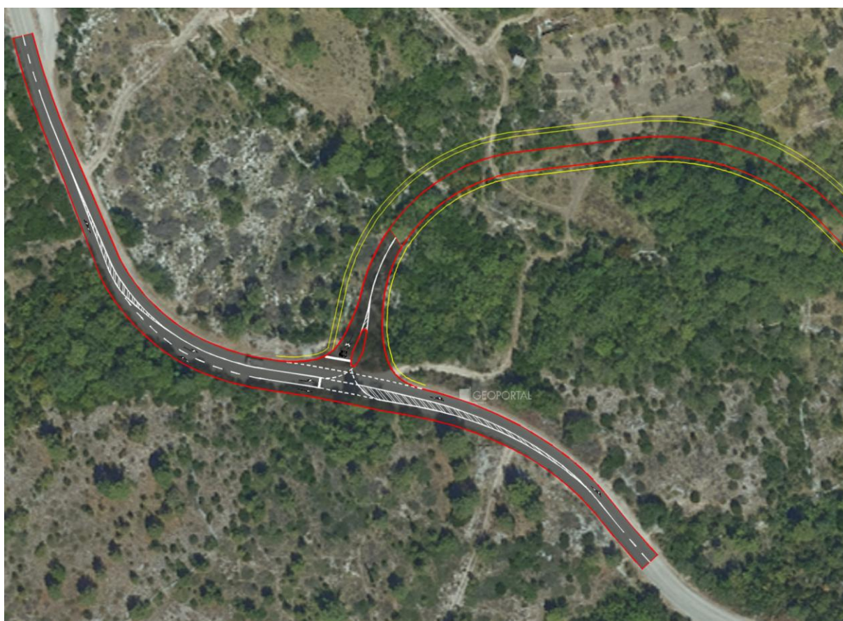
Slika 44: Prijedlog rješenja križanja nerazvrstane ceste za Osojnik s planiranom glavnom prometnicom (sjever)
