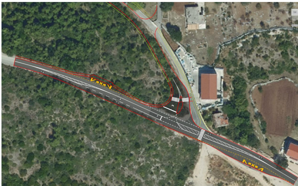
Slika 43: Prijedlog rješenja križanja nerazvrstane ceste za Osojnik s planiranom glavnom prometnicom (jug)
